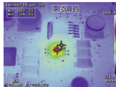
Отладка электронных схем с помощью U5855A
