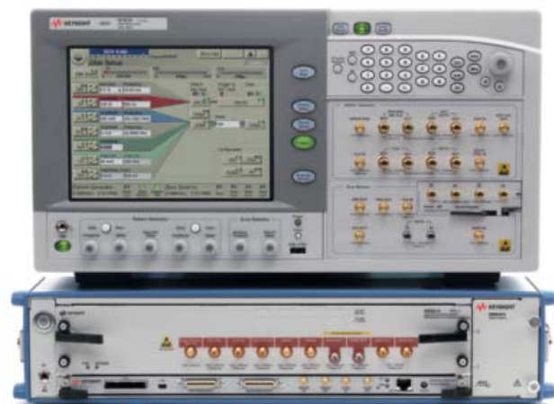
Мультиплексор M8061A может использоваться для увеличения скорости передачи данных тестера J-BERT N4903B до 28,4 Гбит/с
