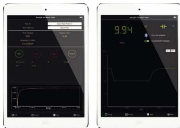
Выполнение дистанционного тестирования с помощью приложения Insulation Tester компании Keysight
