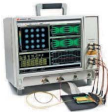
Тестовая установка для проверки характеристик интегрированных когерентных приёмников (ICR)
