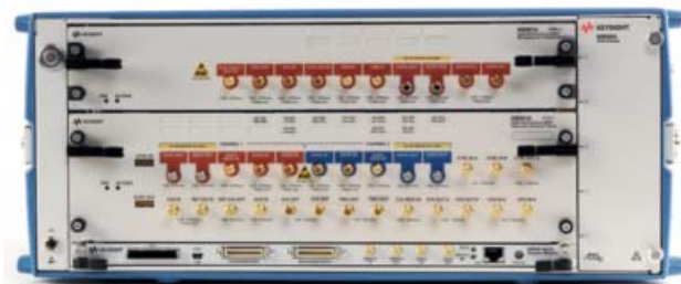
Мультиплексор M8061A используется для увеличения скорости передачи данных тестера BERT J-BERT M8020A до 32 Гбит/с
