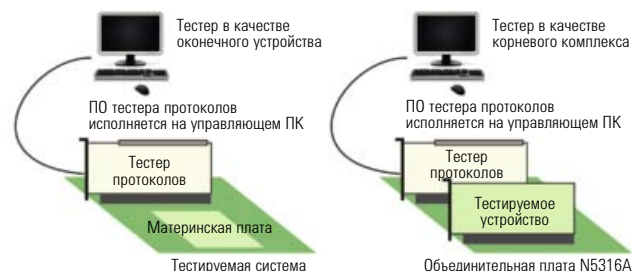
Использование тестера PCIe U4305A в качестве оконечного устройства и корневой комплексы
