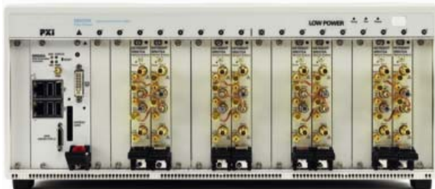
Конфигурация с четырьмя 4-портовыми независимыми ВАЦ
