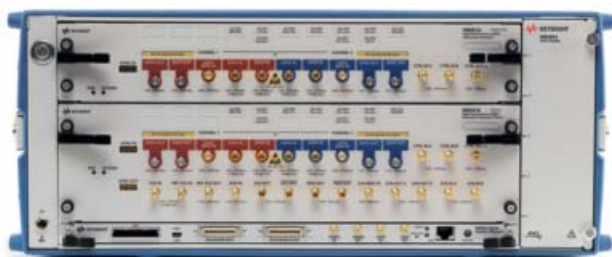
Высокопроизводительный тестер BERT J-BERT M8020A с 4 каналами
